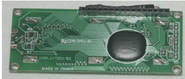
Bild 4: LCD Display mit Buchsenleiste.
