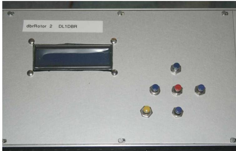
Bild 5: Tastenfeld mit Einbau Tastern (verstärkte Ausführung von Reichelt).
